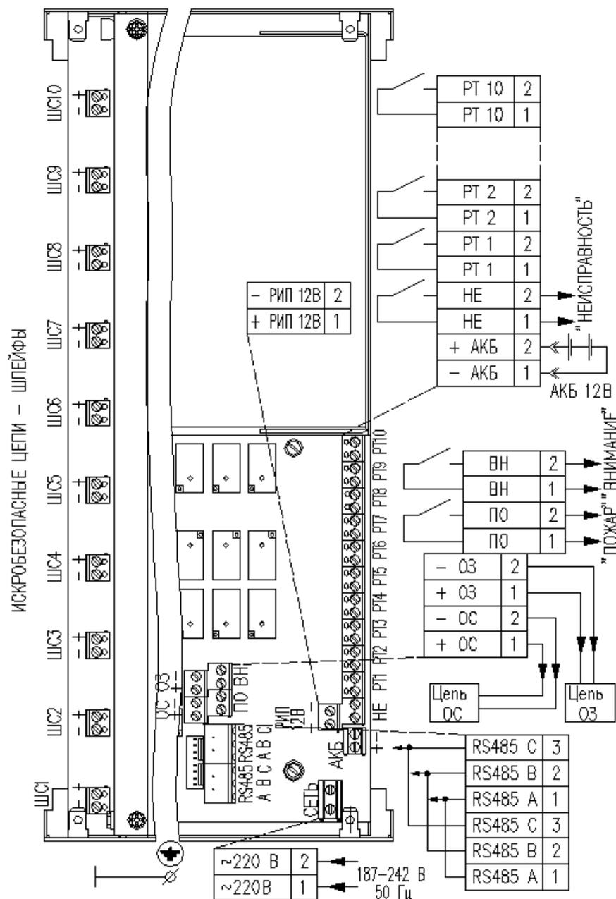
Рисунок А.2 Схема подключения прибора Корунд-20 СИ исп.-01 (10 ШС)
