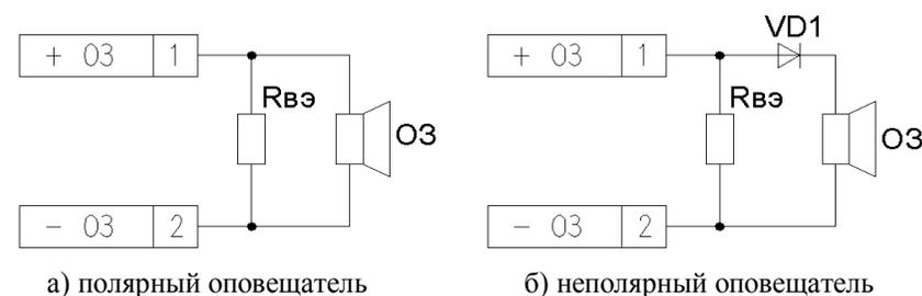
Рисунок Г.2 Схема подключения звукового оповещателя
