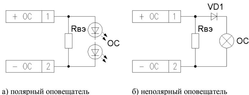
Рисунок Г.1 Схема подключения светового оповещателя
