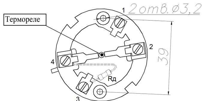
Рис. 1. Общий вид, габаритные и установочные размеры извещателя «МАК-1» исп. 01\* (он же ИБ)
