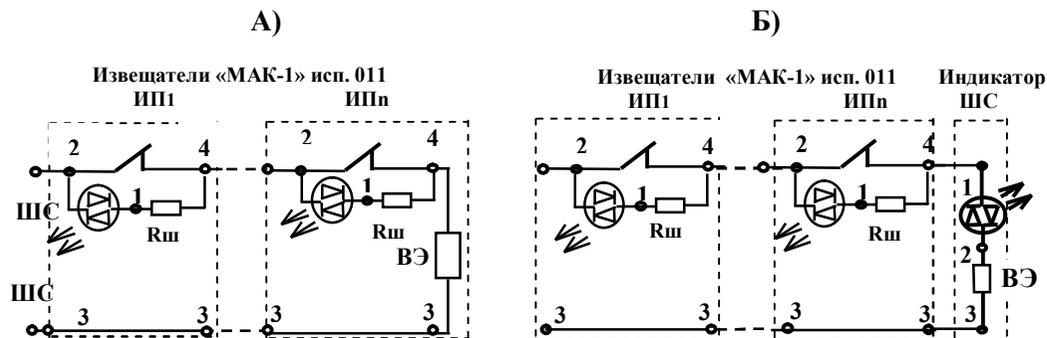
Рис. 2 Варианты включения извещателя с размыкающимся контактом в шлейфы сигнализации пожарных (охранно-пожарных) приемно-контрольных приборов: А) – без выносного индикатора исправного состояния ШС; Б) Вариант с использованием извещателя в качестве индикатора для контроля исправного состояния ШС (при обрыве, КЗ или отсутствии питания ШС индикатор гаснет)
