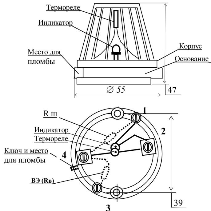
Рисунок 1. Общий вид, габаритные и установочные размеры, расположение элементов в корпусе извещателя «МАК-1» ИБ исп. 011 ИБ
