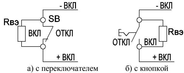
Рис. 6. Схема подключения цепей управления ЦУ, где Рвэ – резистор С1-4-0,25-4,7 кОм ±5% из комплекта прибора
