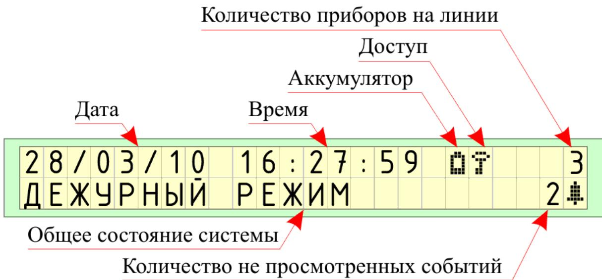
Рисунок 6.1.2 Пример индикации основного экрана.
