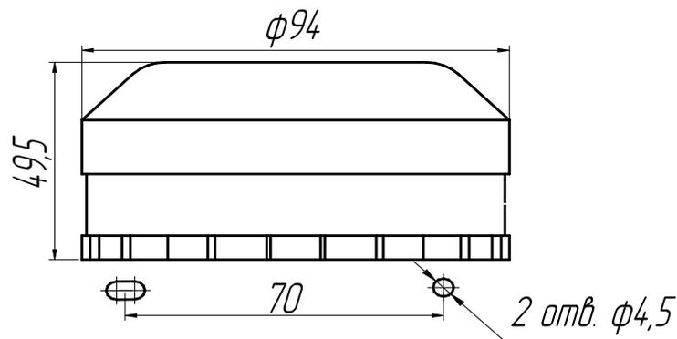
Рисунок 1 - Габаритные и установочные размеры извещателя
