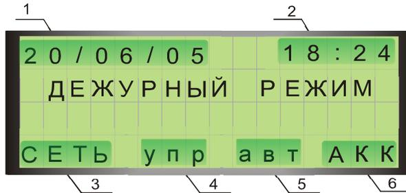
где поле 1 – дата, поле 2 – текущее время, поле 3 – индикатор наличия напряжения основного источника электропитания, поле 4 – индикатор положения замка ДОСТУП (отсутствие сообщения «упр» - замок в положении «ОТКЛ»), поле 5 – индикатор условия работы реле поддержки ШС (сообщение «авт» - поддерживающие реле включаются автоматически при приеме тревожного извещения из ШС) и поле 6 – индикатор состояния аккумулятора;
