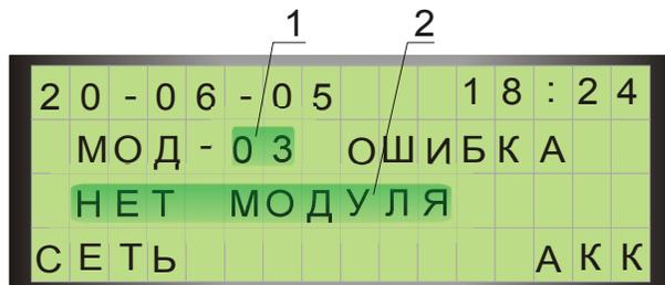
где поле 1 – номер модуля, поле 2 – тип неисправности («НЕТ МОДУЛЯ», «ЛИНИИ СВЯЗИ», «КОРОТКОЕ ЗАМЫК.», «ОШИБКА ОБМЕНА» и т.д.),
